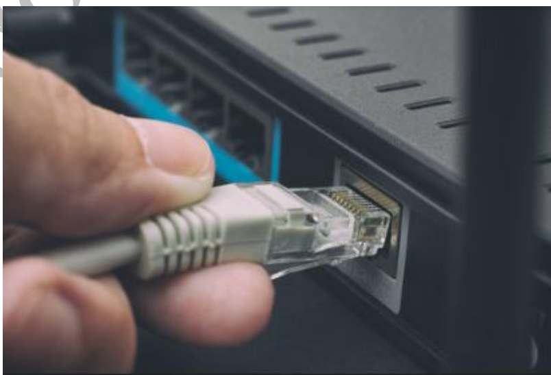
Εικόνα 9: Καλώδια και των θύρες Ethernet
